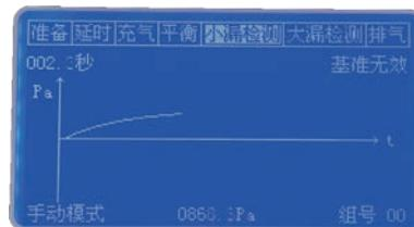
机器自动读取时时检测数据，并使数据坐标化，观察差压变化曲线，判断泄漏变化趋势，解析问题点可以很容易进行。
