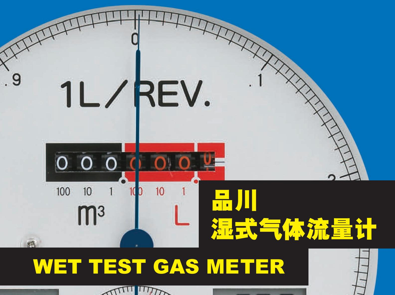
可对0.016L/min的微小流量到750L/min的大流量
